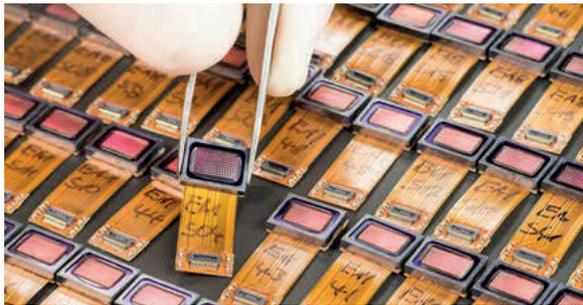
Foto links: Vom Insektenauge inspirierte Miniaturkamera mit 1 Million Pixel Auflösung und sehr hoher Tiefenschärfe. Bild: Fraunhofer IOF
