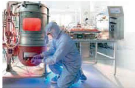
Foto: Einwegbioreaktor mit adaptierter Sensorik
