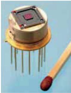
Foto: Minispektrometer zur analytischen Prozessüberwachung in der Lebensmittel- und Pharmaindustrie © InfraTec GmbH
