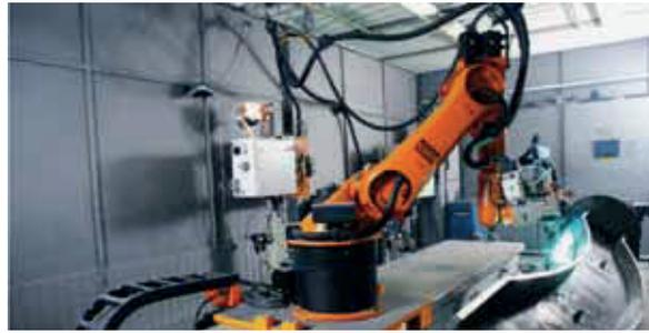
Foto: Flexible Systeme zum Laserschweißen erlauben schnelle Prozessgeschwindigkeiten und hohe Präzision bei geringerer Energieeinbringung in das Bauteil © KUKA Systems GmbH
