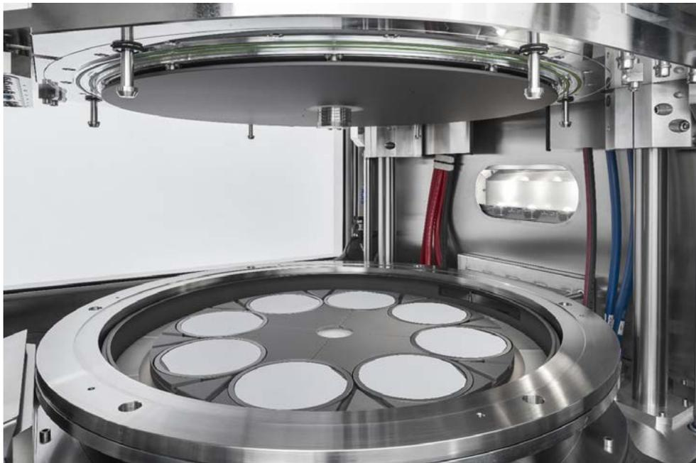
Bild 2: Blick in den Reaktor einer MOCVD-Anlage. (Quelle: Aixtron SE)
