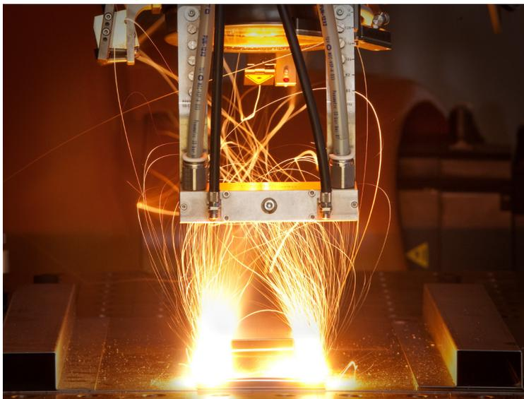
Bild 2: Remote-Schweißprozess. (Quelle: blz/Cvecek)
