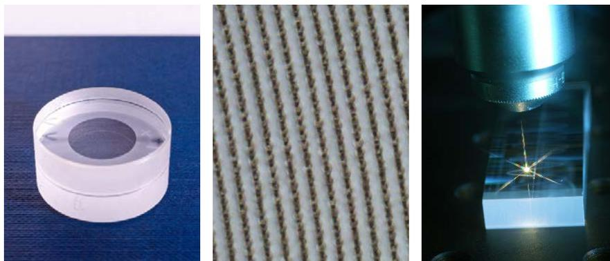
Bild 2: Voruntersuchungen zum Glas-Glas-Laserbonden: (links) UKP-Laser-gebundene Probe aus zwei Quarzglas-Ronden nach dem Eintrag konzentrischer Schmelzlinien im äußeren Probenbereich; (Mitte) Mikroskopaufnahme der eingetragenen Schmelzlinien; (rechts) Laserbondprozess.
