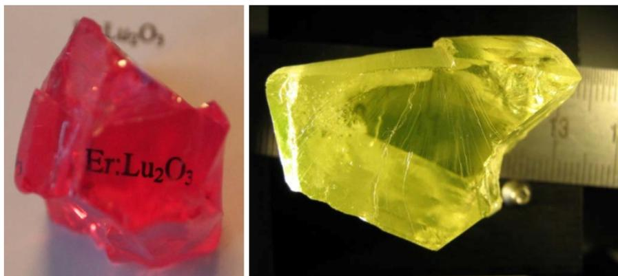
Bild 2: Am Institut für Laser-Physik der Universität Hamburg hergestellte Kristalle, links Er:Lu<sub>2</sub>O<sub>3</sub> und rechts Ho:Sc<sub>2</sub>O<sub>3</sub> (Quelle: Universität Hamburg)
