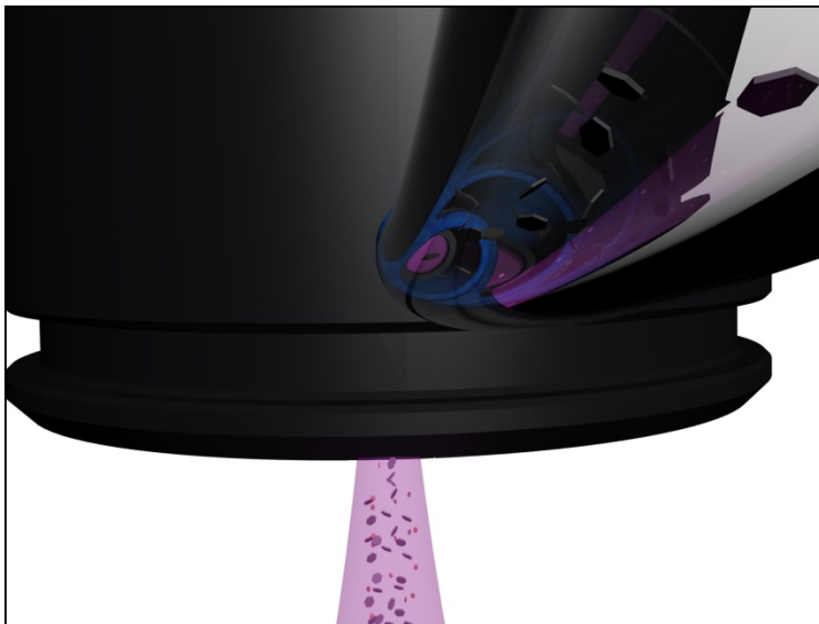
Bild 2: Veranschaulichung der Einspeisung von Aktivkohlepartikeln in den Plasmakopf zur Konfektionierung von Elektroden (Quelle: LLG)
