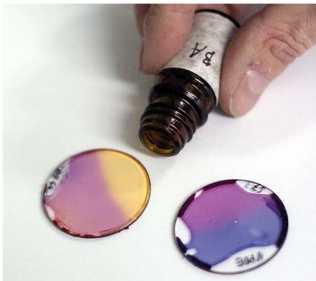
Farbänderung von Sensorfarbstoffen bei Anwesenheit gasförmiger Zerfallsprodukte von Lebensmitteln
