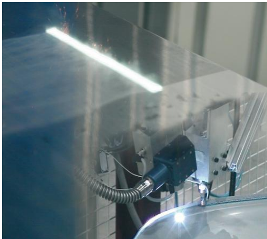
Bild 3: Prozessintegrierte Laservorbehandlung (Quelle: cleanLASER)
