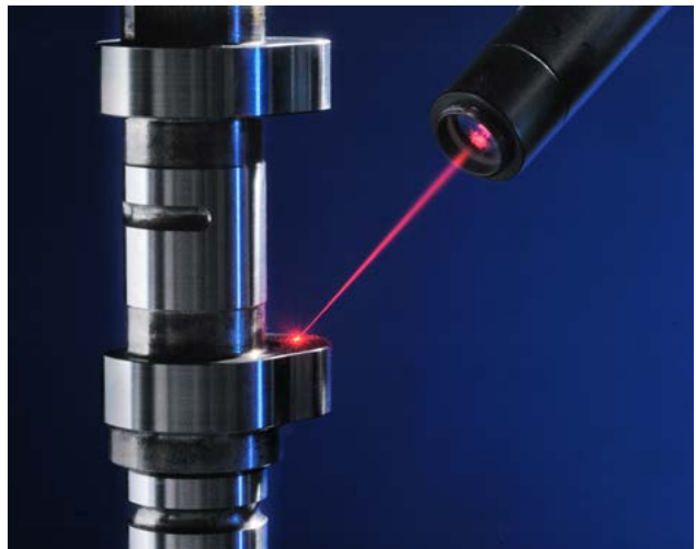
Bild 2: INSPIRE-Sensorik für die Prüfung von Form- und Lagetoleranzen an Nockenwellen. (Quelle: Fraunhofer-Institut für Lasertechnik ILT)
