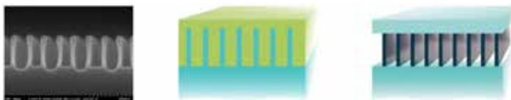
Bild 2: Links abgebildet die REM-Aufnahme eines ungeschützten Metallstreifenpolarisators aus Wolfram für den DUV-Spektralbereich, daneben die Prinzipskizze einer vollständig eingebetteten und rechts einer abgedeckten Struktur. (Quelle: Friedrich Schiller Universität Jena, Institut für angewandte Physik)
