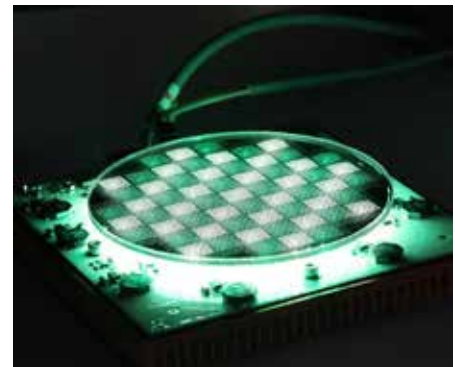
Bild 1: 2D-Array aus 9100 Mikroprojektoren auf einem 4"-Wafer, Dicke 3 mm. (Quelle: Fraunhofer IOF)
