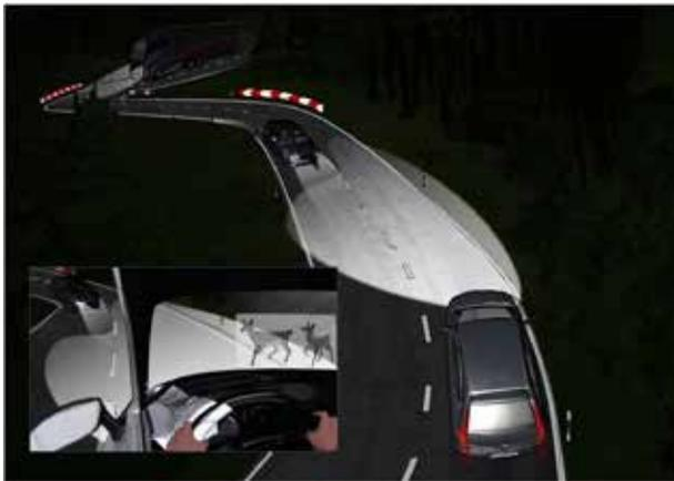
Bild 2: Darstellung der wesentlichen Funktionen Gefahrenlicht, Kurvenlicht und automatisches Fernlicht eines voll-adaptiven Scheinwerfers (Quelle: Osram OS)
