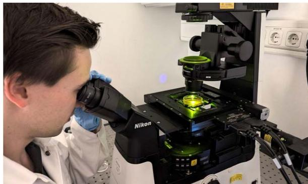
Mikroskopaufbau zur Charakterisierung NIR-fluoreszente CNTs
