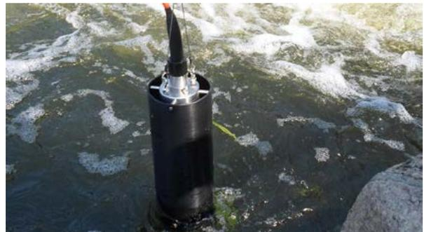
Bild 2: Herkömmliches Gerät zur Profilierung von Cyanobakterienfluoreszenz im Einsatz (Quelle: bbe Moldaenke GmbH)
