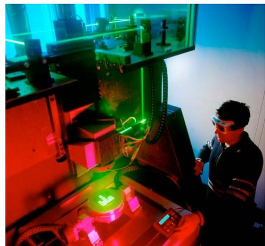
Bild 1: Laserbasierte Erzeugung von Mikrostrukturen mit Hilfe einer 5-Achs-Handhabungseinrichtung
