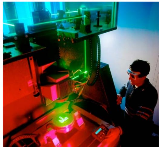
Bild 1: Laserbasierte Erzeugung von Mikrostrukturen mit Hilfe einer 5-Achs-Handhabungseinrichtung
