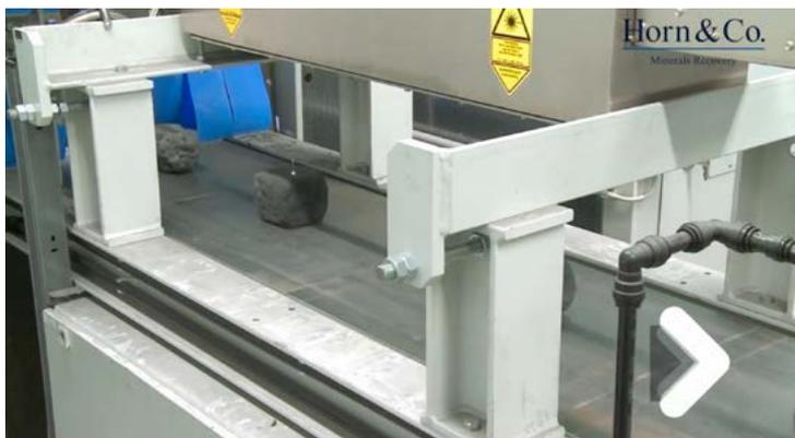
Bild 2: Automatisierte LIBS-Analyse von Feuerfestmaterialien im Wertstoffzentrum Siegerland (Quelle: Mineralmahlwerk Westerwald Horn GmbH & Co. KG)
