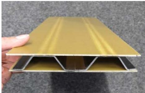
Bild 2: Lasergeschweißte Versteifungsstruktur aus glasfaserverstärktem PEI (Quelle: Laser Zentrum Hannover e.V.)
