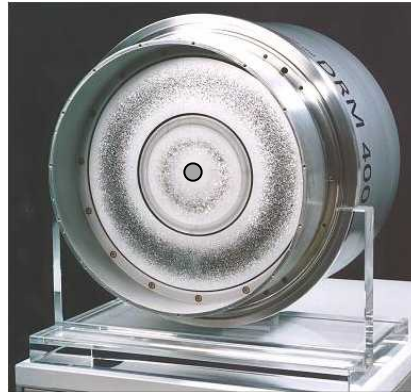
Oben: Double-Ring Magnetron (DRM) Quelle des FEP; Links: LayTec-Messkopf am zentralen DRM-Flansch während der erfolgreichen Vorversuche zum Projekt.
