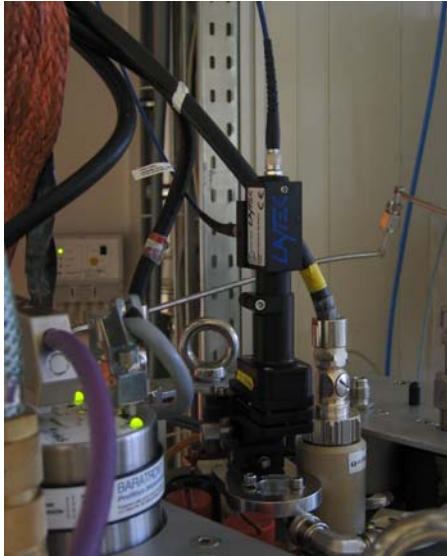
Oben: Double-Ring Magnetron (DRM) Quelle des FEP; Links: LayTec-Messkopf am zentralen DRM-Flansch während der erfolgreichen Vorversuche zum Projekt.
