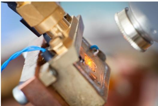
Bild 2: Sensormodul mit einem supraleitenden Einzelphotonensensor und Mikro-Fokus-Optik zur Signaleinkopplung mittels Lichtleitfaser (Quelle: Leibniz Institut für Photonische Technologien / Döring).
