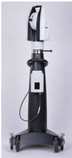
Bild 2: LEICA Absolute Tracker zur präzisen Messung von Distanzen (Quelle: LEICA Geosystems AG).
