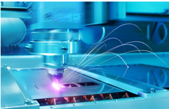
Bild 2: Bearbeitungskopf beim Laserschneiden von dünnen Metallblechen. Die Materialbearbeitung mit Diodenlasern ermöglicht eine flexible, schnelle und kosteneffiziente Produktion.
