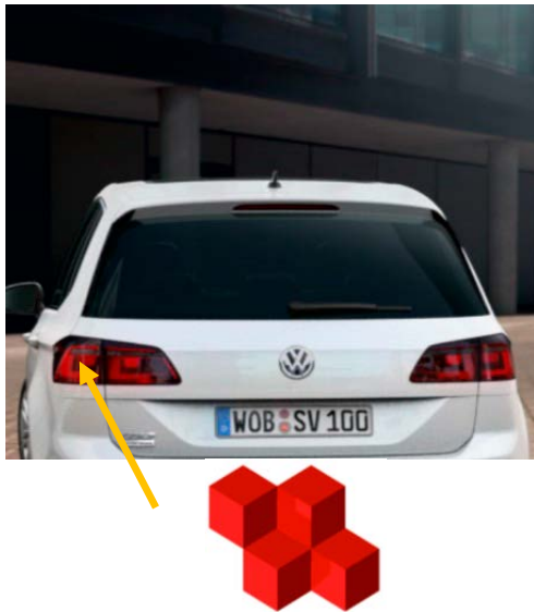
Bild 2: PKW mit separatem Retroreflektor (Pfeil). Darunter der prinzipielle Aufbau eines Retroreflektors aus Tripelspiegeln in hexagonaler Anordnung. Durch Modifikation der Tripel-Reflektorflächen soll die Effizienz gesteigert und damit neue Designs ermöglicht werden. (Quelle: Volkswagen AG)
