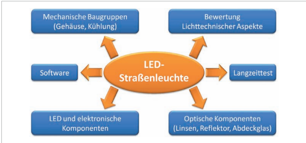
Abbildung 7: Für die Entwicklung relevante Bereiche einer modernen LED-Straßenleuchte © TU Darmstadt
