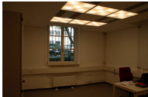
Abbildung 22: Raum mit neutralweißer (links) und warmweißer (rechts) Beleuchtung im direkten Vergleich © TU Darmstadt
