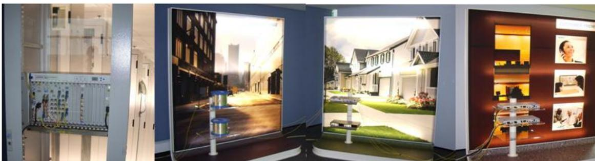
Bild 2: Optical Line Termination (OLT) in der Vermittlungsstelle (links), Verzweigungs- und Verteilereinrichtungen in den passiven Remote Nodes am Straßenrand (Mitte), Optical Networking Unit (ONU) beim Teilnehmer (rechts). (Quelle: ADVA AG)
