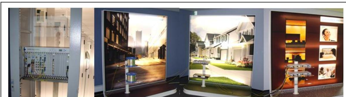
Bild 2: Optical Line Termination (OLT) in der Vermittlungsstelle (links), Verzweigungs- und Verteileinrichtungen in den passiven Remote Nodes am Straßenrand (Mitte), Optical Networking Unit (ONU/CPE) beim Teilnehmer (rechts). (Quelle: ADVA AG)
