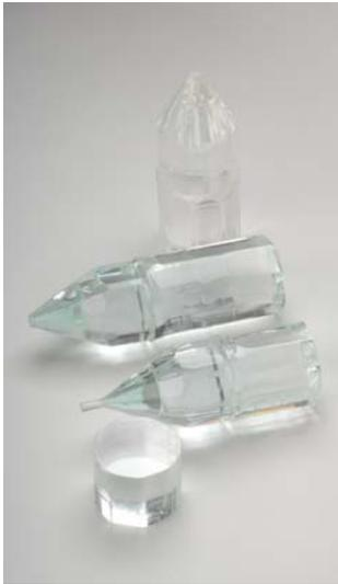
Bild 2: Neuartige Laserkristalle erlauben die stabile Erzeugung ultrakurzer Laserpulse bei mittleren Ausgangsleistungen im kW-Bereich (Quelle: FEE GmbH)
