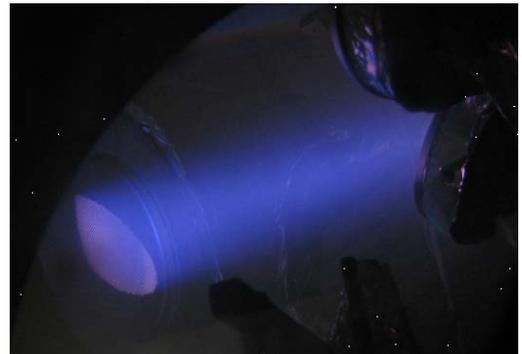
Bild 2: Ionenstrahlquelle in einer Beschichtungsanlage nach dem Ionenstrahl-Zerstäubungskonzept (Ion Beam Sputtering, IBS) für die Herstellung hochwertiger optischer Schichtsysteme.
