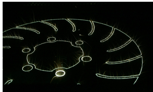
Bild 1: Langzeitaufnahme der Konturbelichtung bei der additiven Fertigung einer Schleifscheibe
