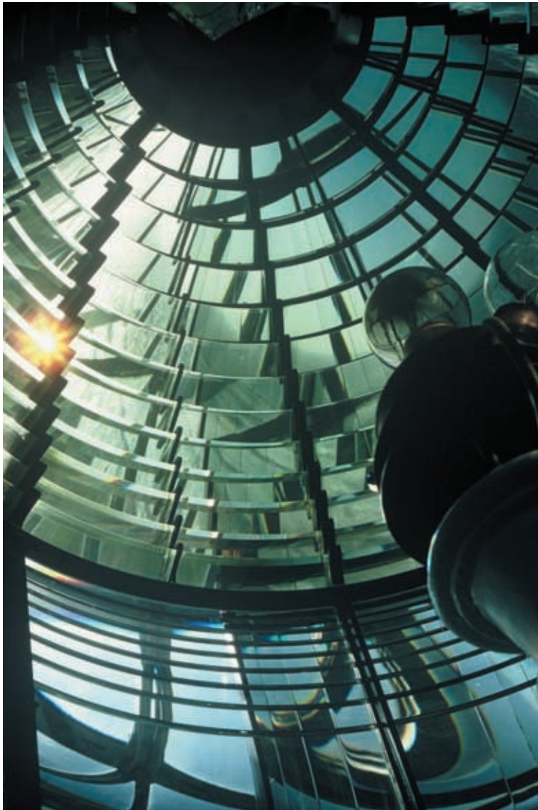
Lichtkuppeln von Leuchttürmen: Eine große Fresnellinse formt den Lichtstrahl
