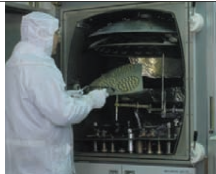
Höchste Reflexionsgrade oder spezielle Leistungsmerkmale für optische Komponenten durch dielektrische Beschichtung (Fotos: LINOS Photonics, Laseroptik; Diagramm: Laseroptik).
