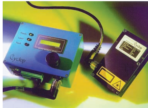
Ansicht eines Laser-Triangulationssensors, rechts: Sensor-kopf, links: Steuereinheit. (Foto: Fh-Institut für Lasertechnik (Fh-ILT)).
