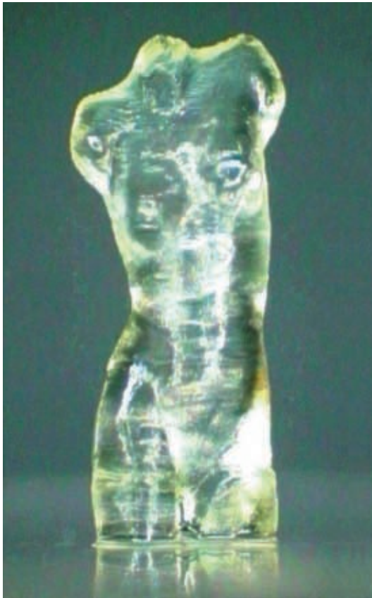
Mikro-Venus (ca. 3 mm hoch), per Laser aus Glas geschnitzt, Laserinnengravur (Fotos: Laser Zentrum Hannover, Fh-Institut für Lasertechnik (Fh-ILT)).
