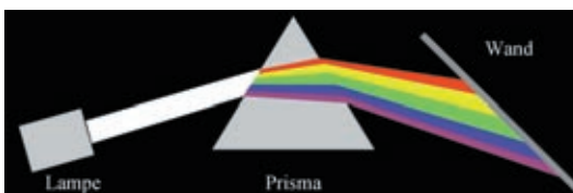
Schematische Darstellung der spektralen Zerlegung eines weißen Lichtbündels mit Hilfe eines Prismas.
