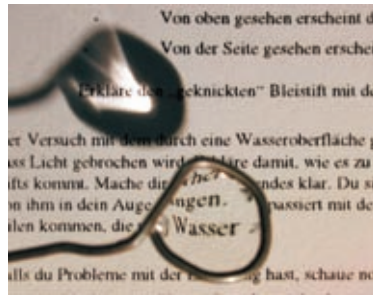
Ein in einer Drahtschleife fixierter Wassertropfen kann als einfache Lupe benutzt werden.
