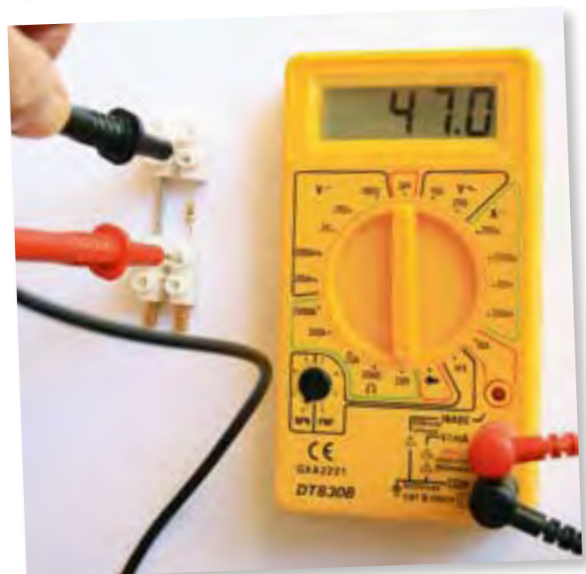
Auch der Widerstand lässt sich mit dem Messgerät leicht bestimmen. Messgerät hierzu im Widerstandmessmodus auf die passende Größenangabe schalten.
