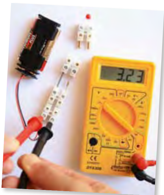
Mit einem Messgerät (Multimeter) lässt sich die Spannung leicht messen. Messgerät hierzu im Gleichspannungsfeld auf die passende Größenangabe schalten.
