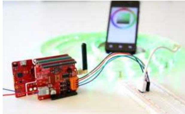
Bild 2: Open Source Plattform bestehend aus HW (Infineon Arduino kompatibel Shield) und SW (Color Wheel auf dem Handy für die Steuerung der Licht) und Licht (LED Strip). (Quelle: Infineon Technologies AG)
