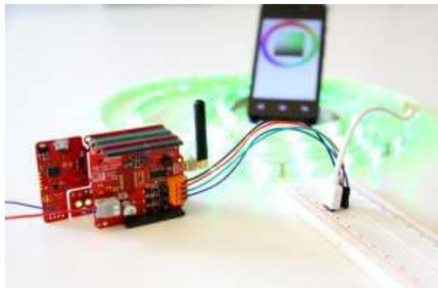
Bild 2: Open Source Plattform bestehend aus HW (Infineon Arduino kompatibel Shield) und SW (Color Wheel auf dem Handy für die Steuerung der Licht) und Licht (LED Strip) (Quelle: Infineon Technologies AG)
