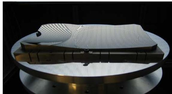
Freiformspiegelpaar aus Direkttherstellung mittels Ultrapräzisionsbearbeitung (Quelle: Carl Zeiss Jena GmbH)
