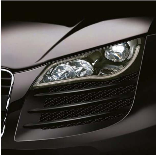
LED-Scheinwerfer im Premiumsegment - Der Audi R8 verfügt als erstes Serienfahrzeug über einen vollständig LED-basierten Hauptscheinwerfer (Quelle: Automotive Lighting)
