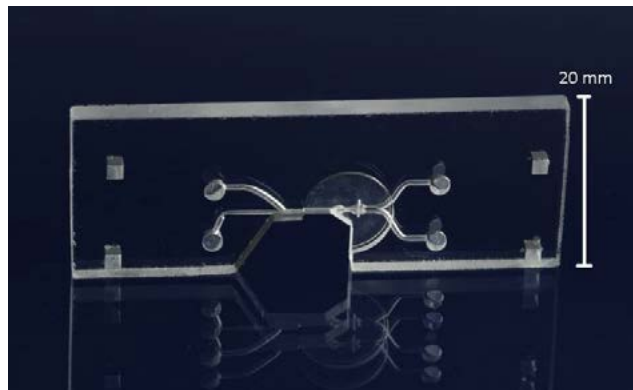
Bild 2: Kanalstruktur in Glas, erzeugt durch laserinduziertes Ätzen nach der Bestrahlung mit fs-Laserpulsen. (Quelle: Fraunhofer Institut für Lasertechnik, Aachen)
