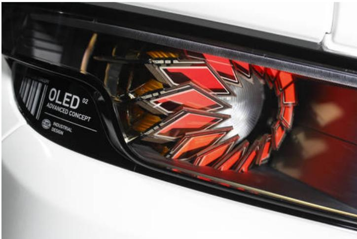
Bild 2: Demonstrator einer automobilen Heckleuchte mit 16 starren OLED Module (Quelle: Hella KGaA Hueck & Co.)
