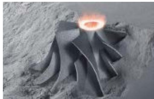
Bild 1: Additive Fertigung metallischer Bauteile mittels Laser Metal Fusion (LMF). (Quelle: TRUMPF Gruppe)
