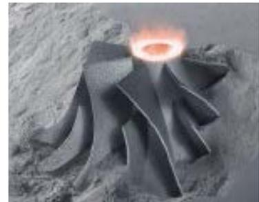
Bild 1: Additive Fertigung metallischer Bauteile mittels Laser Metal Fusion (LMF)
