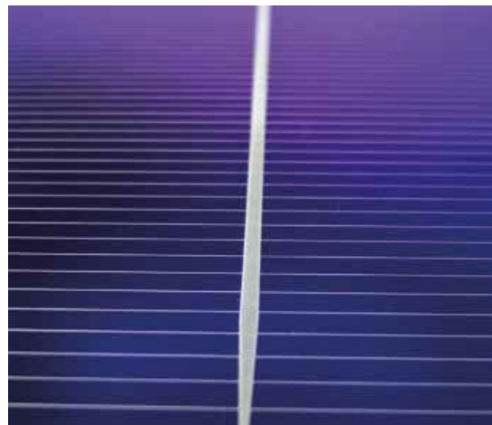
Bild 1: Mit Flexo-Druck hergestellte Frontseitenmetallisierung einer Solarzelle (Quelle: Fraunhofer ISE)
