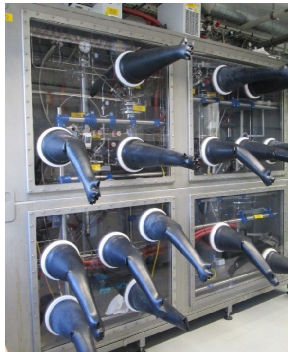
Bild 2: Anlage zur Herstellung von chemischen Präkursoren (Quelle: Umicore AG & Co. KG)
