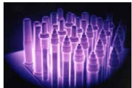
Bild 1: Plasma birgt enorme Potentiale zur Bearbeitung und Veredelung von Oberflächen. Hier: Plasmadiffusionsbehandlung von Werkzeugen (Quelle: FhG-IST, IOT, Braunschweig)
